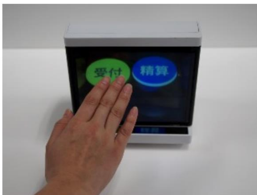
コンパクトタイプの「空中入力装置」に表示したボタンを非接触で操作
